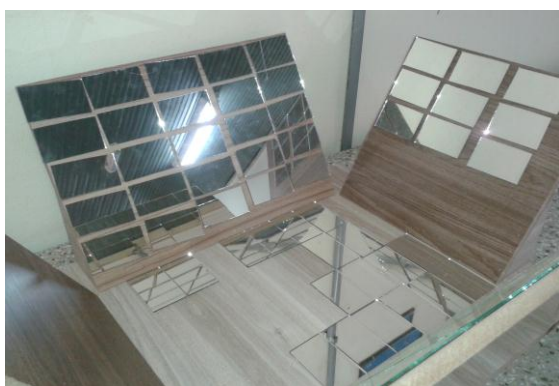
Figura 2 – Confeção concentrador solar
